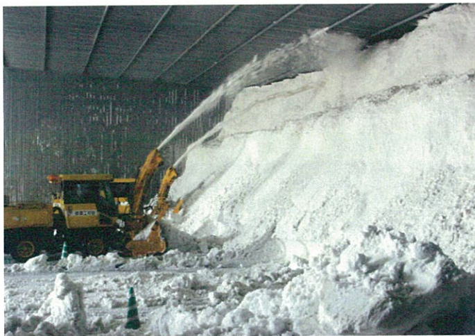
ＪＡは雪エネルギーを活用した米穀雪零温貯蔵施設の雪蔵工房と、利雪型予冷库の雪蔵美人への雪入れ作業を行った。今年は昨年に比べ積雪が約 3.3 倍、平年より約 1.4 倍と多かった。そのため昨年は市内の雪をかき集めての作業となったが、今年は同ＪＡが管理する施設内の雪で充分足りる量を確保できた。同工房の貯雪室前に集められた雪はブルドーザーで均され、ホイールローダー 2 台が雪室内に押し込み、ロータリー除雪機 2 台が天井まで雪を積み上げ、約 3,600 ㍓の雪を貯め込んだ。一方、雪蔵美人では約 100 ㍓の雪をハードコンテナ 72 基に納め、予冷库に積み上げた。ＪＡは 2001 年から雪蔵工房を稼働。09 年からは雪の低温と高湿度な特性をアスパラガスなどの予冷を活用した利雪型予冷库「雪蔵美人」を稼働している。(03/09 ～ 10)
